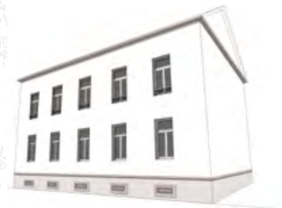
Das Gebäude nach Entfernung aller Gliederungselemente z.B. im Rahmen einer Außendämmung. Die Fassade verliert ihr Gesicht.
