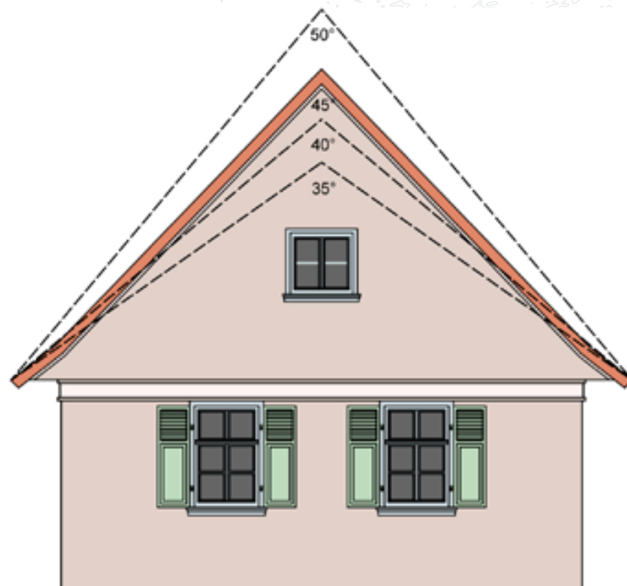
Typische Dachneigung Ortstypische Dachneigungen im Fördergebiet liegen zwischen 35° und 50°
