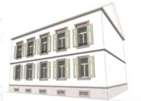
Das Gebäude mit vorhandenen Gliederungselementen und den früher montierten Klappläden
